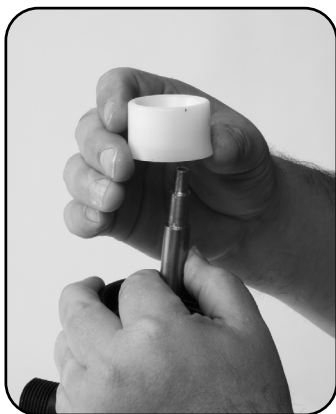
Step 4. Remove #44 DOSAGE PISTON.
